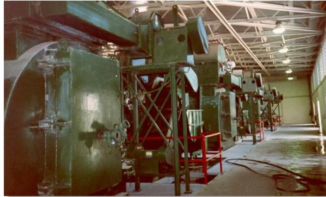
*Systèmes de combustion des déchets à double réacteur multi-modulaires*
