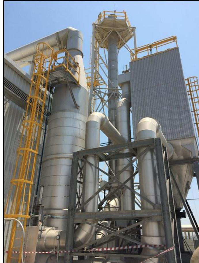
*Refroidisseur-évaporateur avec épurateur-dépoussiéreur à sec et colonne*
