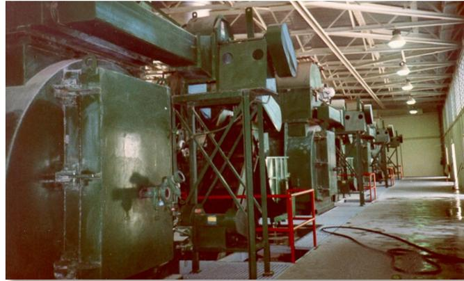
*Múltiples sistemas modulares de combustión de desperdicios con doble reactor*
