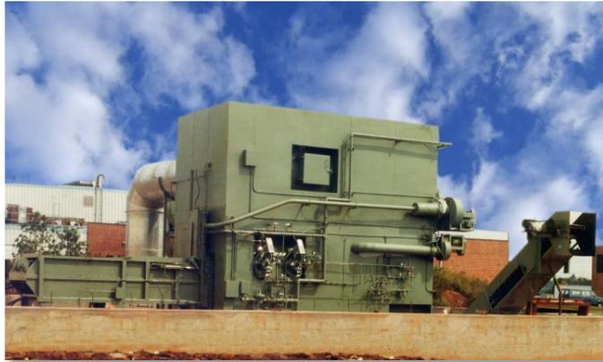
*Sistema de tratamento de resíduos farmacêuticos com recuperação de calor e remoção automática de cinzas*
